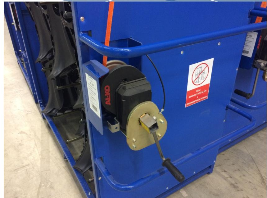
Automatische Bremse - verbunden mit der Handwinde
